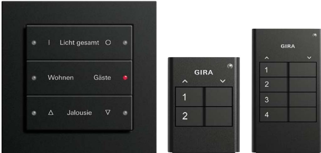
Die batteriebetriebenen Gira KNX RF Tastsensoren können als Funk-Wandsender unabhängig von Netz- und Bus-Leitung überall platziert werden, wo Bedienelemente gewünscht sind: Verschraubt auf der Wand, per Tragrings auf einer UP-Gerätedose oder mit Klebestreifen auf glatten Flächen. Die Tastsensoren senden KNX Telegramme aus, die sich über die ETS vielfältig parametrisieren lassen.
