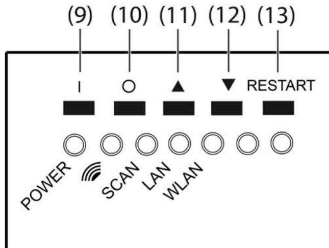
Bild 2: Tasten des eNet Servers für die Handbedienung
