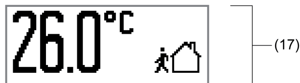
Bild 51: Beispiel für eine Grundanzeige mit einem Anzeigebereich (Raumtemperatur, Betriebsmodusanzeige)
