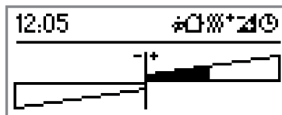
Bild 58: Beispiel einer 2-Bereichs-Anzeige mit Basis-Sollwertverschiebung als Bargraph
