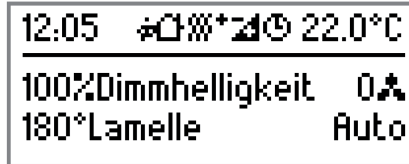
Bild 56: Beispiel einer 2-Bereichs-Anzeige mit 2-zeiliger Wertanzeige inkl. ergänzendem Text Zeile 1 Helligkeitswert, Zeile 2 Lamellenwinkel
